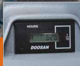
Počítadlo hodin (z úrovně terénu)
