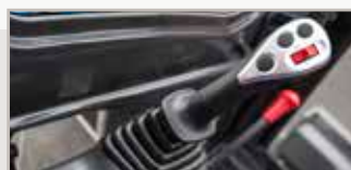
Proporcionální joystick s pomocným ovládním palcem
