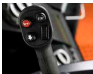
Joystick s otočným kolečkem a F/R
