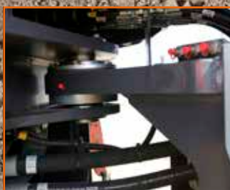
Dobře uspořádané a snadno přístupné spoje v kloubovém závěsu.
