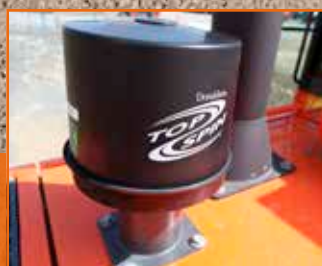
Odstředivý předřazený čistič Top Spin™ Donaldson®
