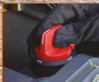
Přepínač odpojení baterie
