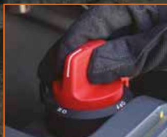
Přepínač odpojení baterie
