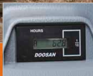
Počítadlo hodin (z úrovně terénu)
