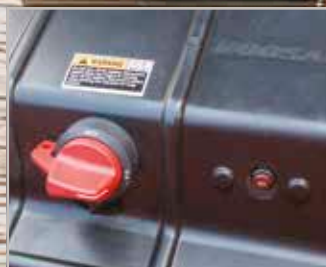
Přepínač odpojení baterie
