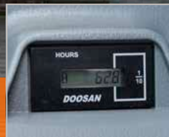
Počítadlo hodin (z úrovně terénu)
