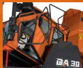
Bezpečnostní zábradlí kolem celé kabiny
