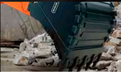
LŽÍCE DEVELON TŘÍDY S (MĚKKÉ HORNINY)
